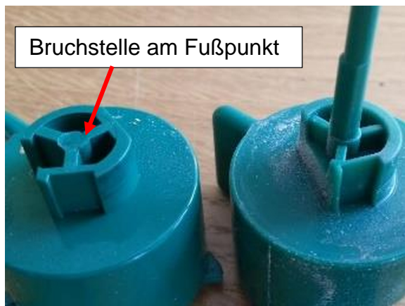
Abbildung 6: Vergleich defekter/intakter Schalter
